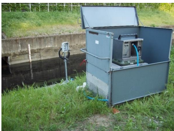
Figura 39 – Autocampionatore installato sul T. Seveso
