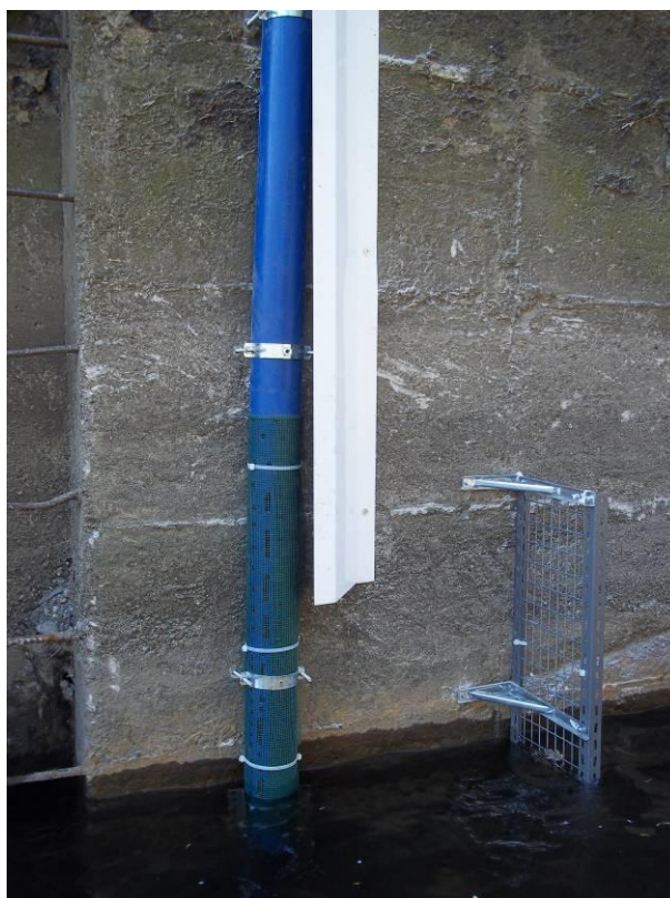
Figura 38 – Installazione della sonda S/N 13M101703 all'interno del T. Seveso
