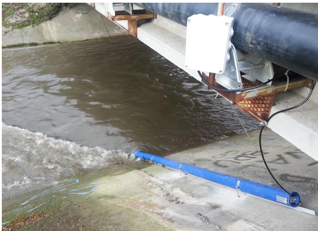
Figura 37 – Installazione della sonda S/N 13M101704 all'interno del CSNO
