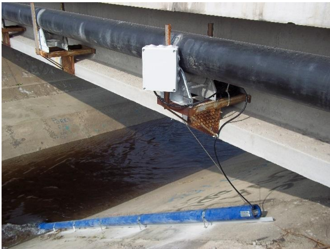
Figura 36 – Sonda multiparametrica YSI 6920 V2 della da YSI Inc.
